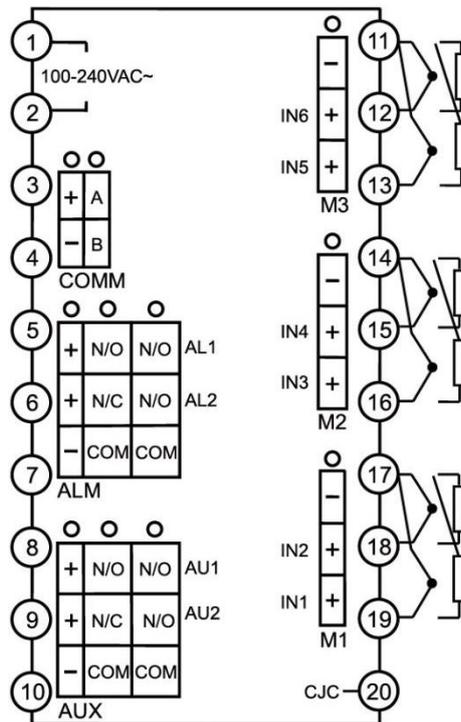
注: 本图为 A、C、E 型竖式面板的式仪表接线图。
