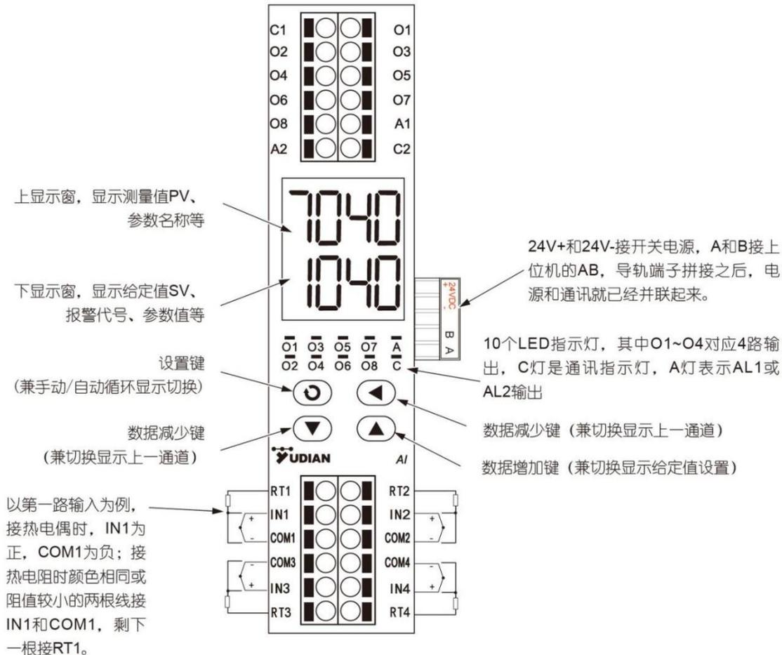
AOP 用于定义输出点的对应关系，其中 1 对应 O1 (OP1) ,2 对应 O2 (OP2) ,3 对应 AL1,4 对应 AL2,5 对应 O3 (AU1) ,6 对应 O4 (AU2) 。
